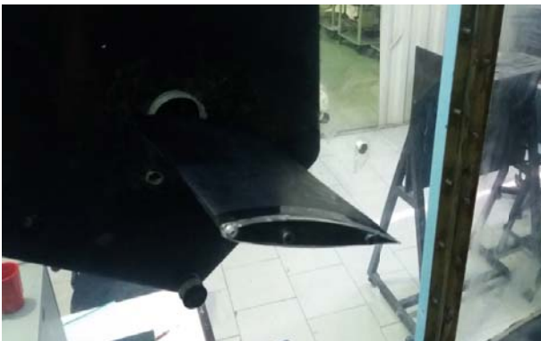
شکل ۳- تصویر بال نصب شده و بالانس خارجی در تونل باد
